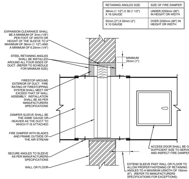
**FIRE DAMPER - FUSIBLE LINK DETAIL**
